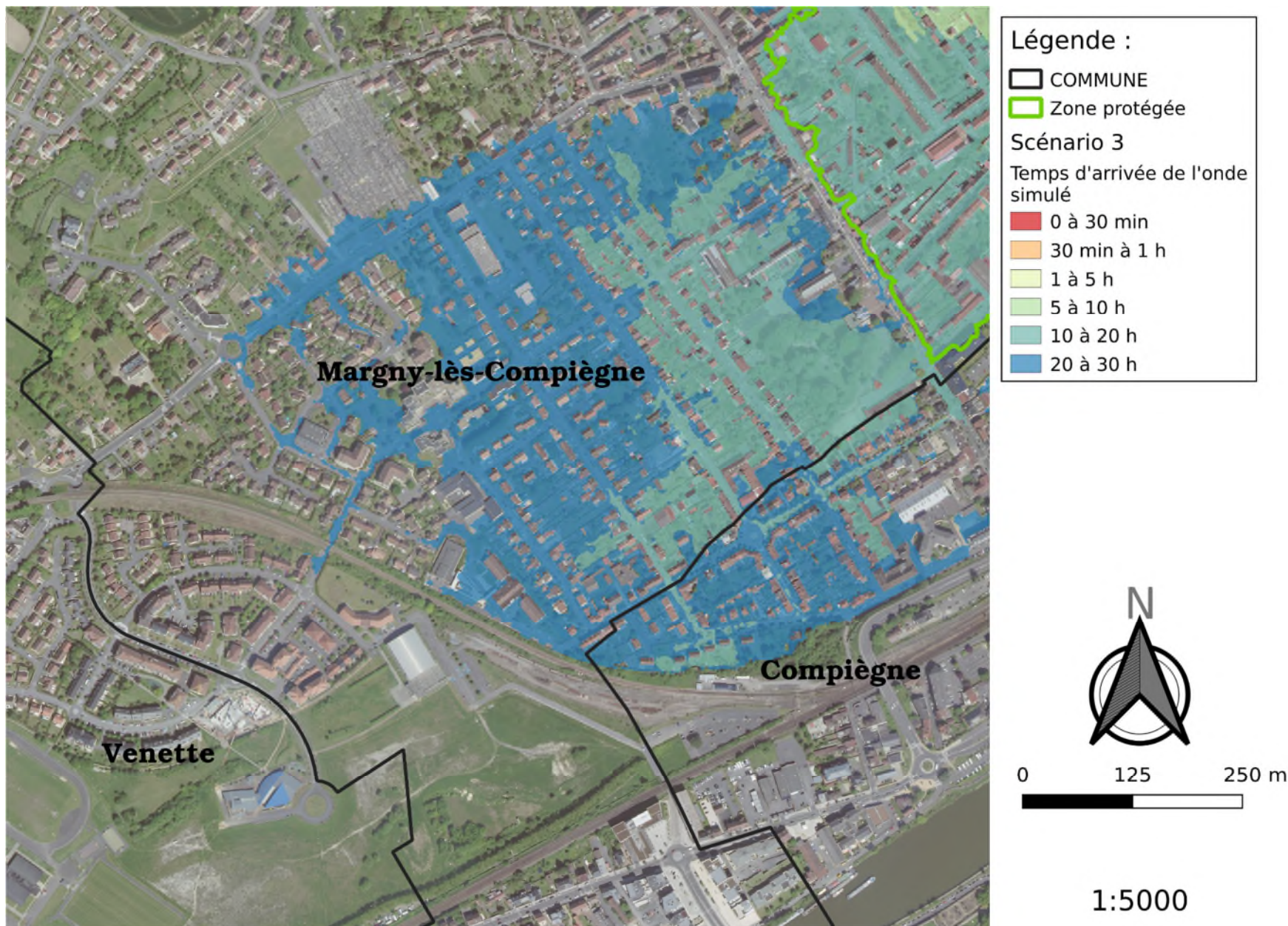
Figure 107 : Portion S.-O. hors ZP n°2 ; temps de propagation du front d'eau depuis la brèche (source : Artelia)
