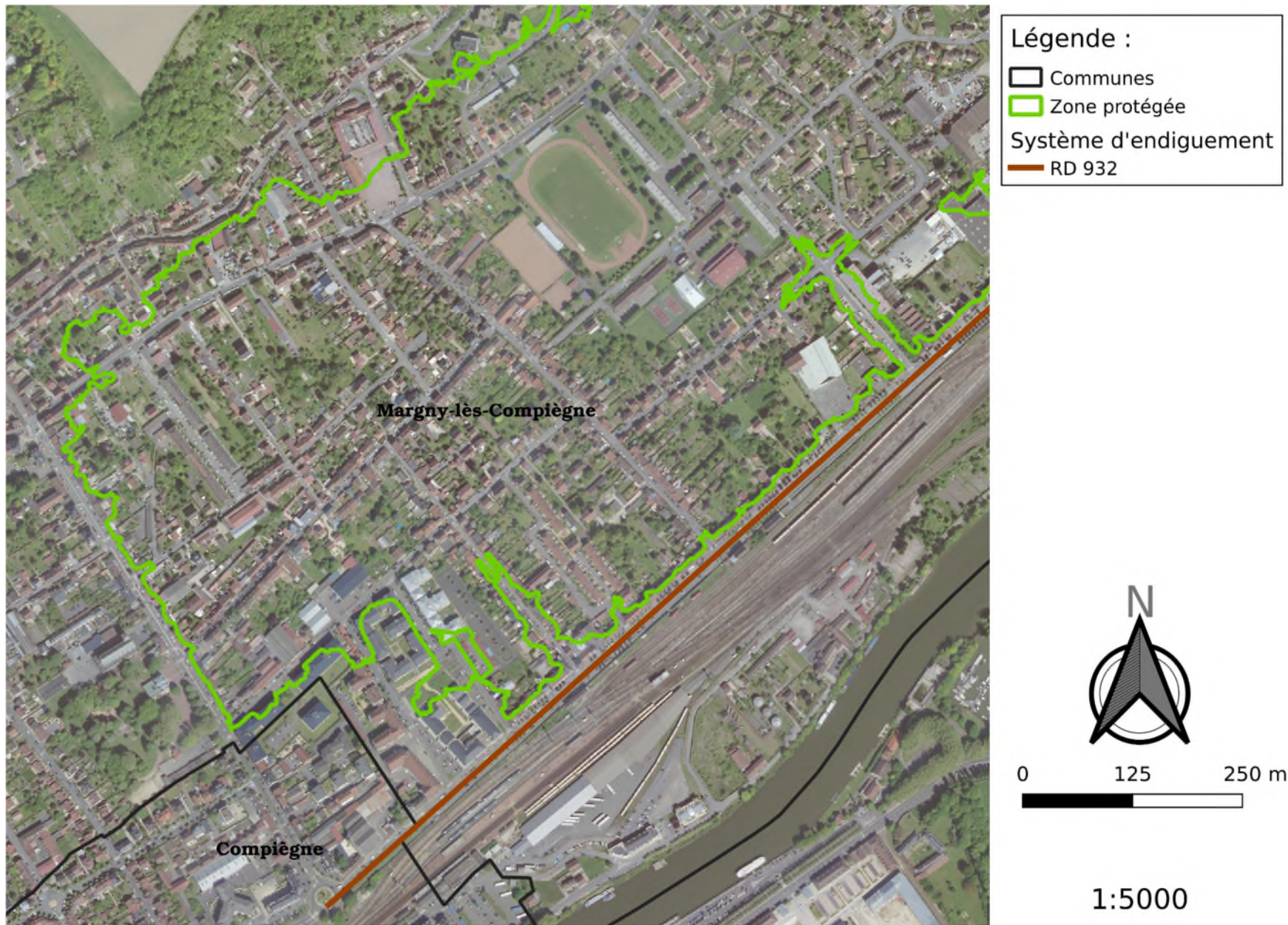
Figure 85 : Limites de la zone protégée dans sa partie S.-O. (source : Artelia)
